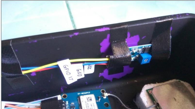
**Gambar 6.5** Rangkaian Sensor *Vibration* Aplikasi SmartCar
