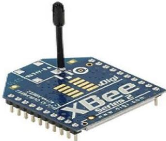
**Gambar 1.5** Module ZigBee
